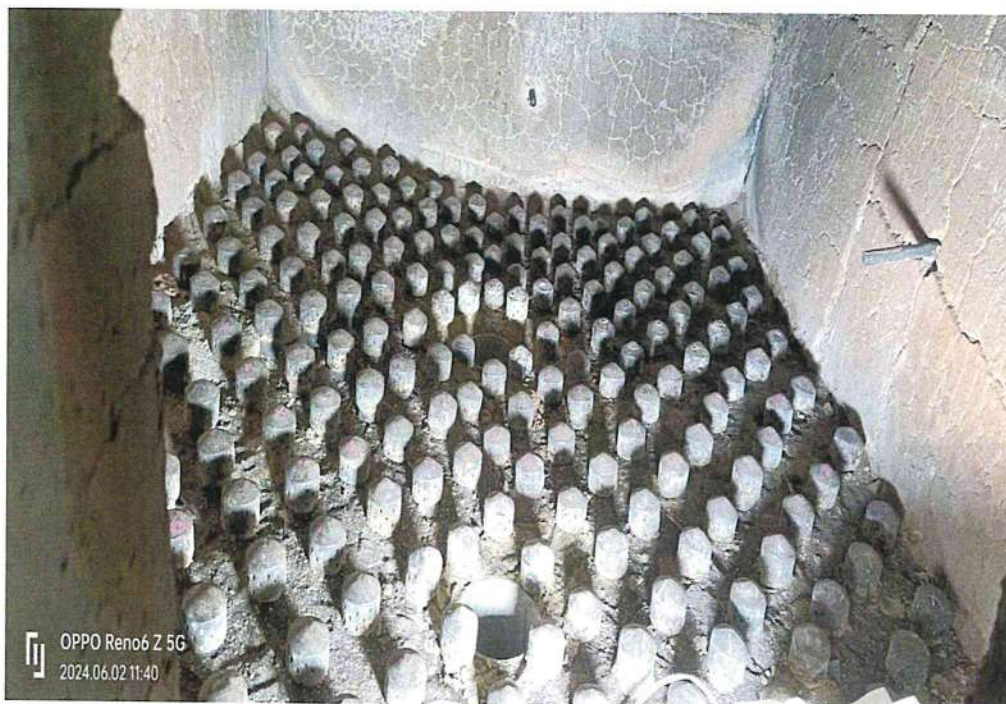
สภาพ Air nozzle ใน Furnace
